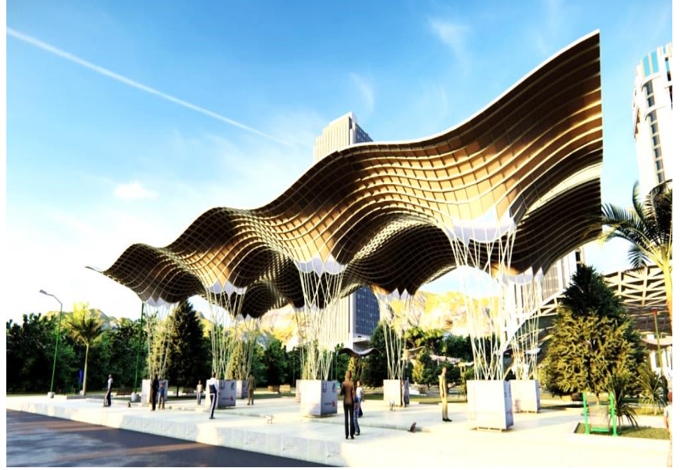
شكل رقم (18) يوضح الفكرة التصميمية (3) لتوظيف خامة النسيج الكهروضوئي بشكل جمالي ووظيفي في الفراغ المعماري الخارجي.
